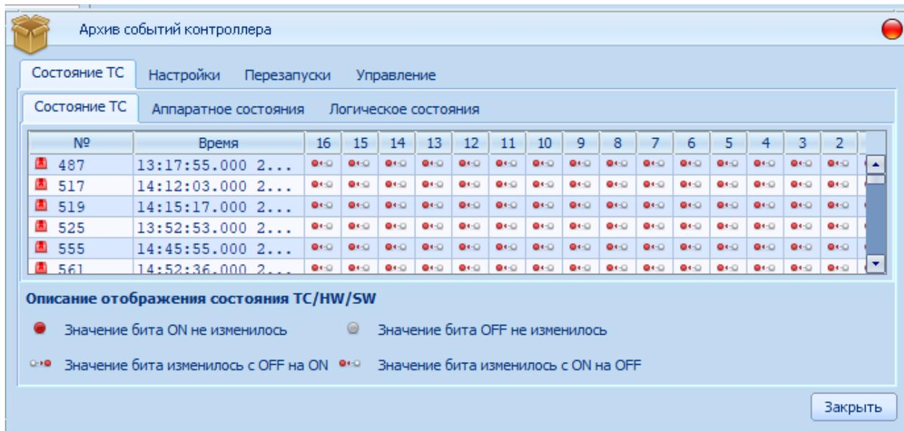
Рис. 8. Вкладка «Состояние ТС » архива событий контроллера.
