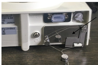
Рисунок 2 – Схема пломбировки от несанкционированного доступа, обозначение места нанесения знака поверки (1 – свинцовая или пластиковая пломба со знаком поверки в виде оттиска поверительного клейма)
