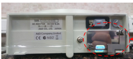
Рисунок 2 - Схема пломбировки весов от несанкционированного доступа
