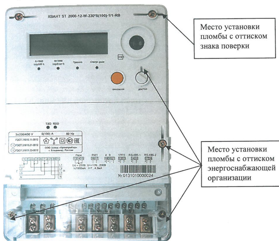
Рисунок 1 - Общий вид счетчика непосредственного включения в корпусе типа W
