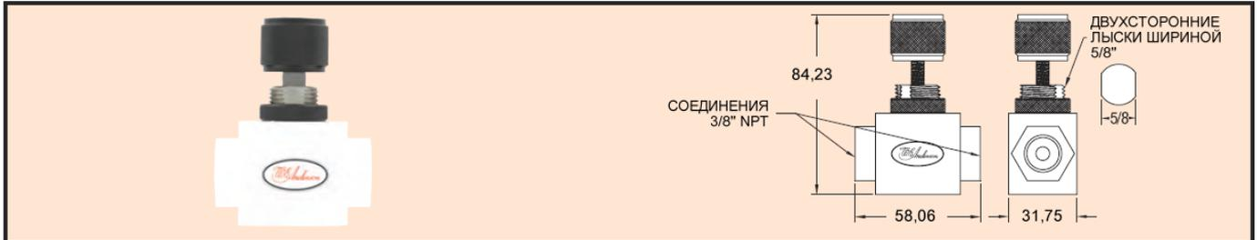
**Игольчатый клапан из ПТФЭ модели TNV** сконструирован для лабораторных и промышленных приложений для регулировки коррозионноактивных газов и жидкостей для работ в высокочистых условиях. Среда находится в контакте только с ПТФЭ и PCTFE. Штоки клапанов сделаны из заостренного PCTFE для минимизации «деформации» обычно связываемой с ПТФЭ. Модель TNV создана для использования в приложениях с давлением и второстепенным вакуумом и может использоваться как отсекающий клапан.
