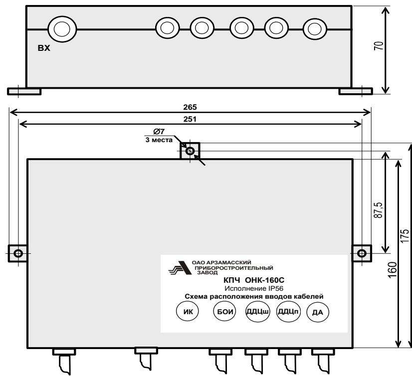
Рисунок 13 - Габаритные и присоединительные размеры КПЧ
