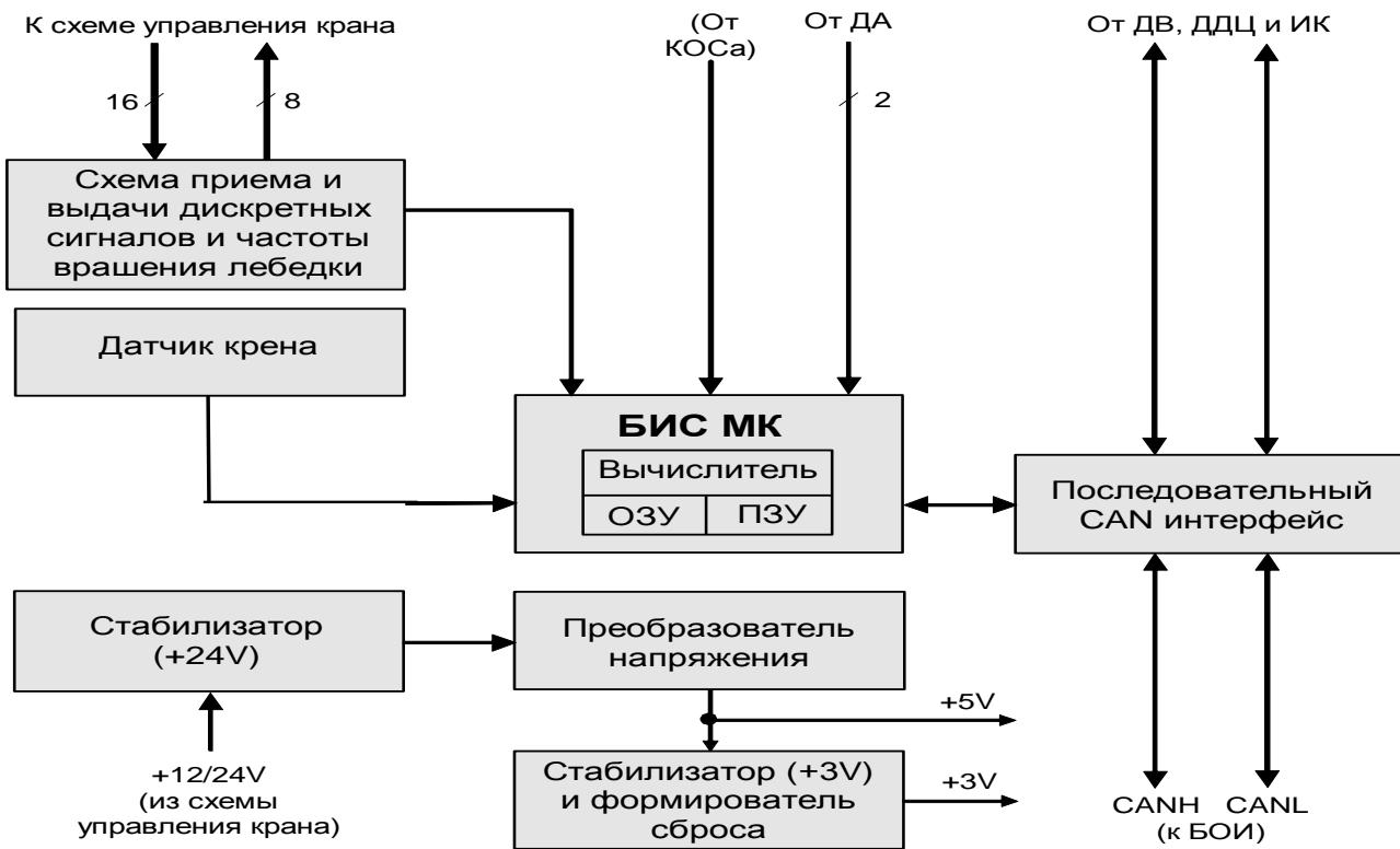
Рисунок 4 - Блок-схема КПЧ
