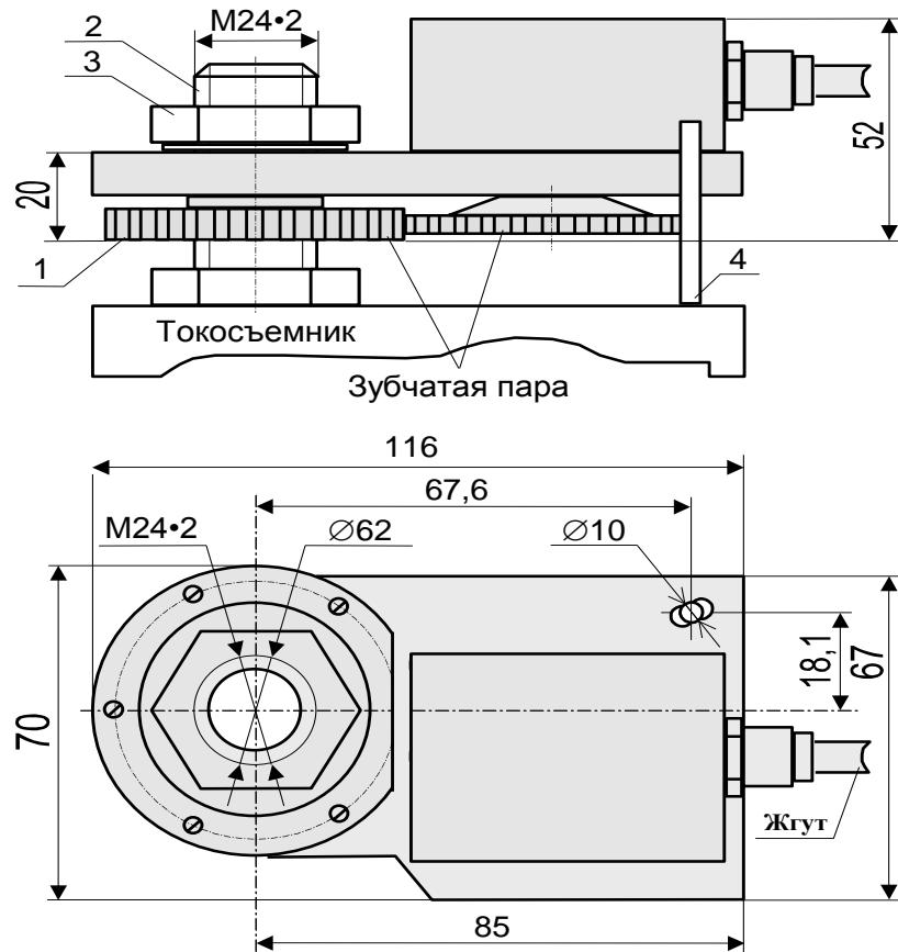
Рисунок 12 - Установка датчика азимута
