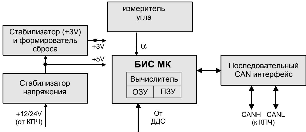
Рисунок 7 - Блок-схема ДНС
