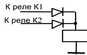
Рисунок 16 Варианты подключения выходных реле (электронных ключей)
