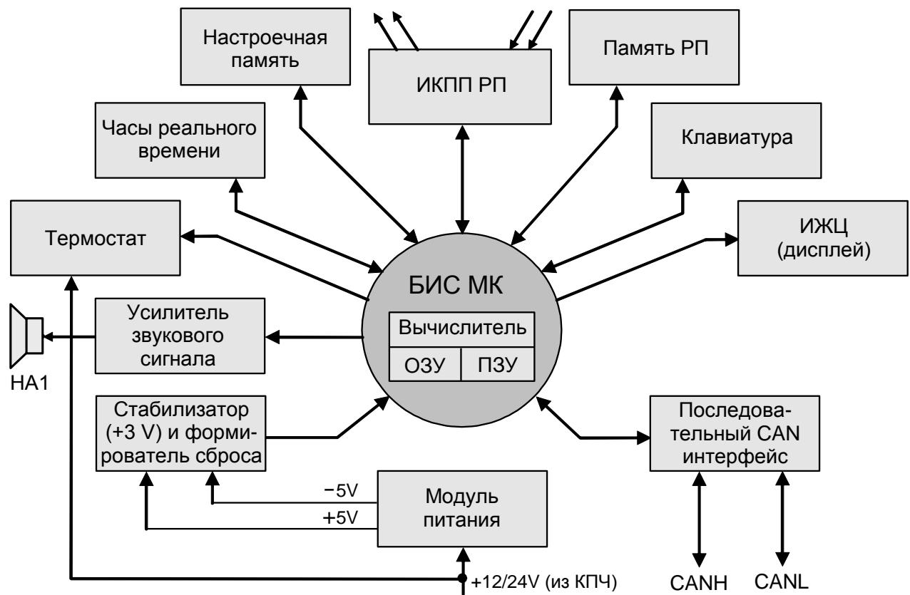
Рисунок 2 - Блок-схема БОИ
