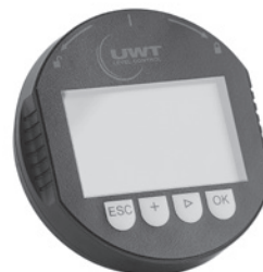
Модуль индикации и настройки (Поз 9)
