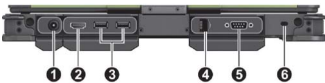
Рис. 3. DCU 220, вид сзади 1 Разъем питания 2 HDMI-порт (внешний монитор/ТВ) 3 Порт USB 3.0 4 Порт RJ-45 (LAN) 5 Порт последовательного интерфейса 6 Соединение под кенсингтонский замок
