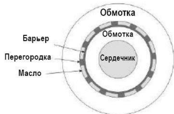
Рис. 3. Типичная структура изоляции
