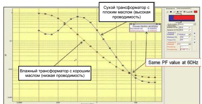
Рис. 7. Синий цвет: Сухой трансформатор с плохим маслом
