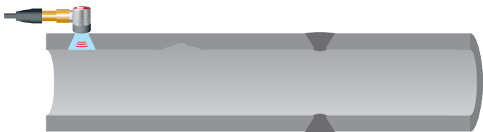
При традиционном УЗК сканируется зона, расположенная непосредственно под датчиками или вблизи них.
