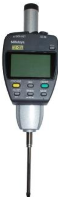
Рисунок 3 – Головки измерительные цифровые ABSOLUTE серии 543 модель ID-F
