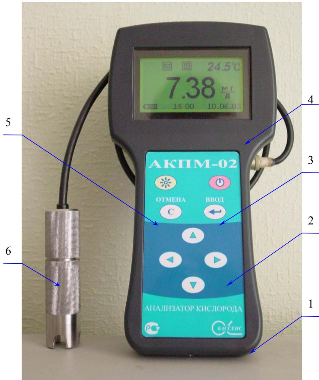
Рис. 4.1. Внешний вид анализатора кислорода АКПМ-02.
