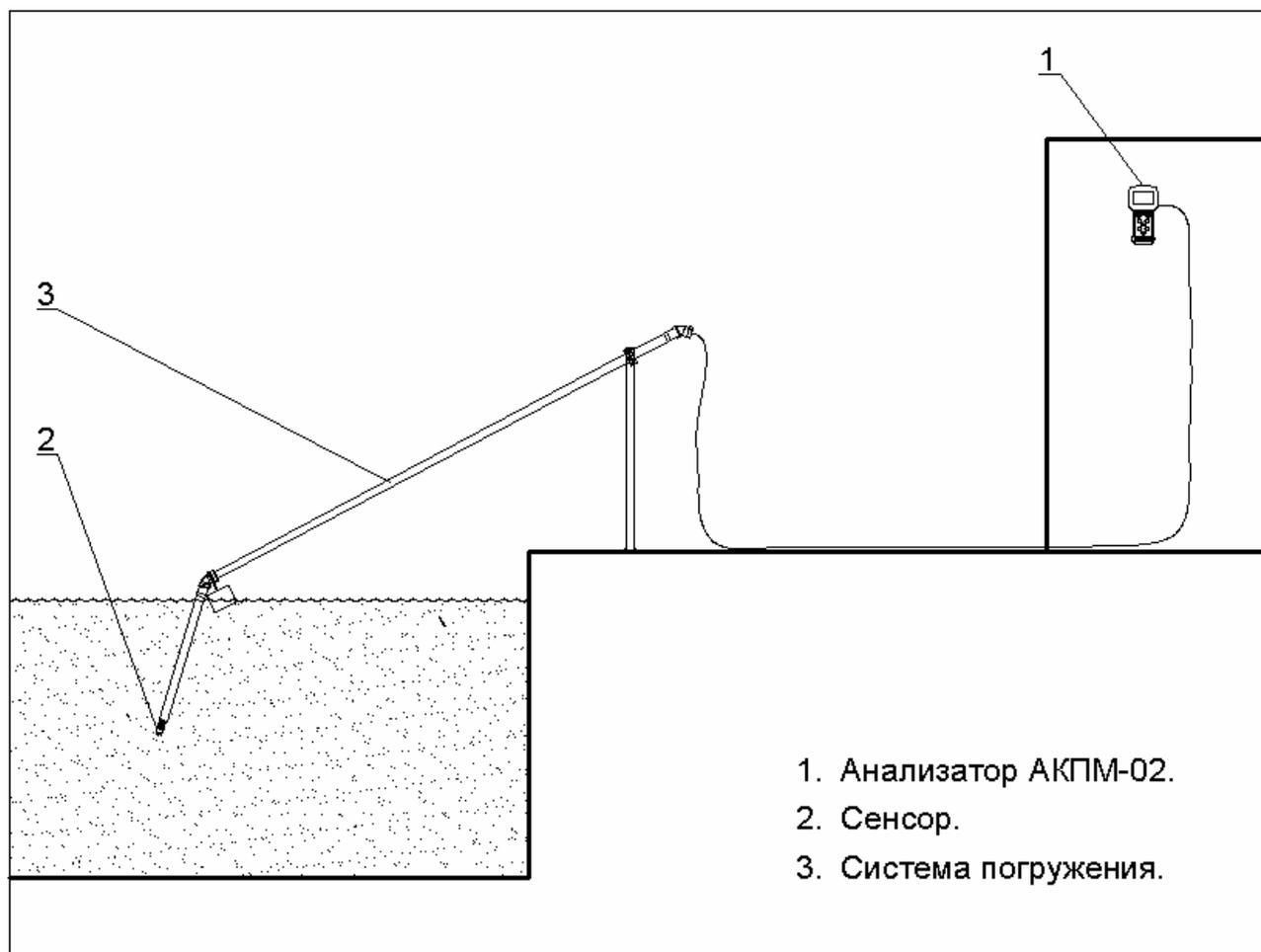
Рис. 10.5 Схема установки АСрО<sub>2</sub> в аэротенке с помощью системы погружения.
