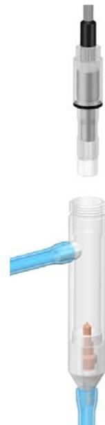
Рис. 3.9. Установка АСрО<sub>2</sub> в измерительную камеру.
