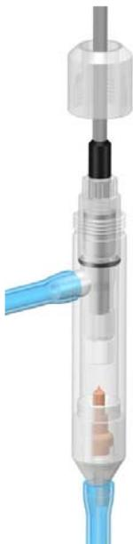
При установке АСрО<sub>2</sub>-05 в герметичную ячейку сначала осторожно вставьте сенсор в верхний корпус ячейки (см. рис. 3.4), а затем закрутите нижний корпус до упора (см. рис. 3.3).
