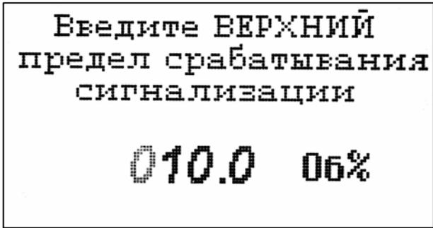
Рис. 8.3-14 Окно настройки верхнего предела срабатывания сигнализации.
