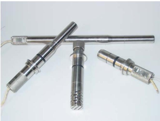
Сенсоры АСрО<sub>2</sub>-06 поставляются в комплекте с анализатором АКПМ-02Б. Они выполнены в корпусах из нержавеющей стали и имеют универсальные типоразмеры для их установки в ферментеры и биореакторы отечественного и зарубежного производств. Эти сенсоры выдерживают неограниченное количество циклов стерилизации острым паром при T=143 °C и P=3 ати.
