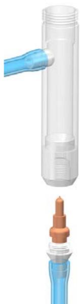
Измерительные камеры для анализа в потоке газов (ИКПГ) и в потоке жидкостей (ИКПЖ) показаны на рис. 3.2, рис. 3.9 и рис. 3.10. Конструкции этих измерительных камер отличаются от ИКМА расположением входного и выходного штуцеров, а также способом герметизации АС.
