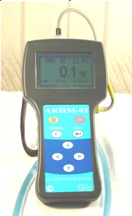
Рис. 2.3. Внешний вид анализатора АКПМ - 02П.
