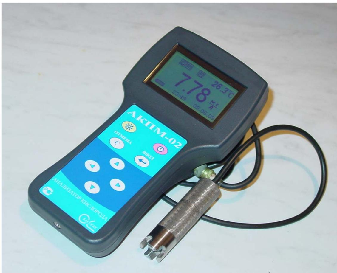
Рис. 1. Внешний вид анализатора кислорода АКПМ-02 с  $ASrO_2-05$
