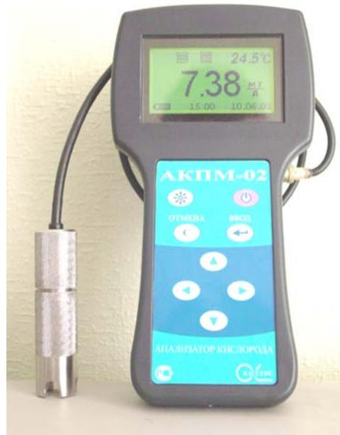
Рис. 2.4. Внешний вид анализатора АКПМ-02П.
