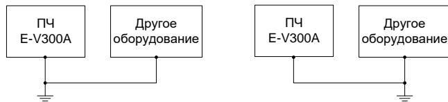
в) Плохой способ заземления
