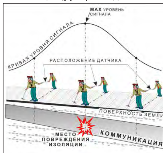
применение датчика-определителя дефектов коммуникации (ДОДК) методом max
