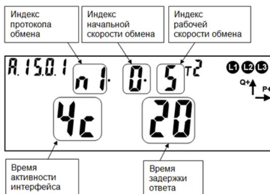
Рисунок 27 – Настройка оптического интерфейса связи по протоколу ГОСТ IEC 61107-2011 (проприетарная реализация)
