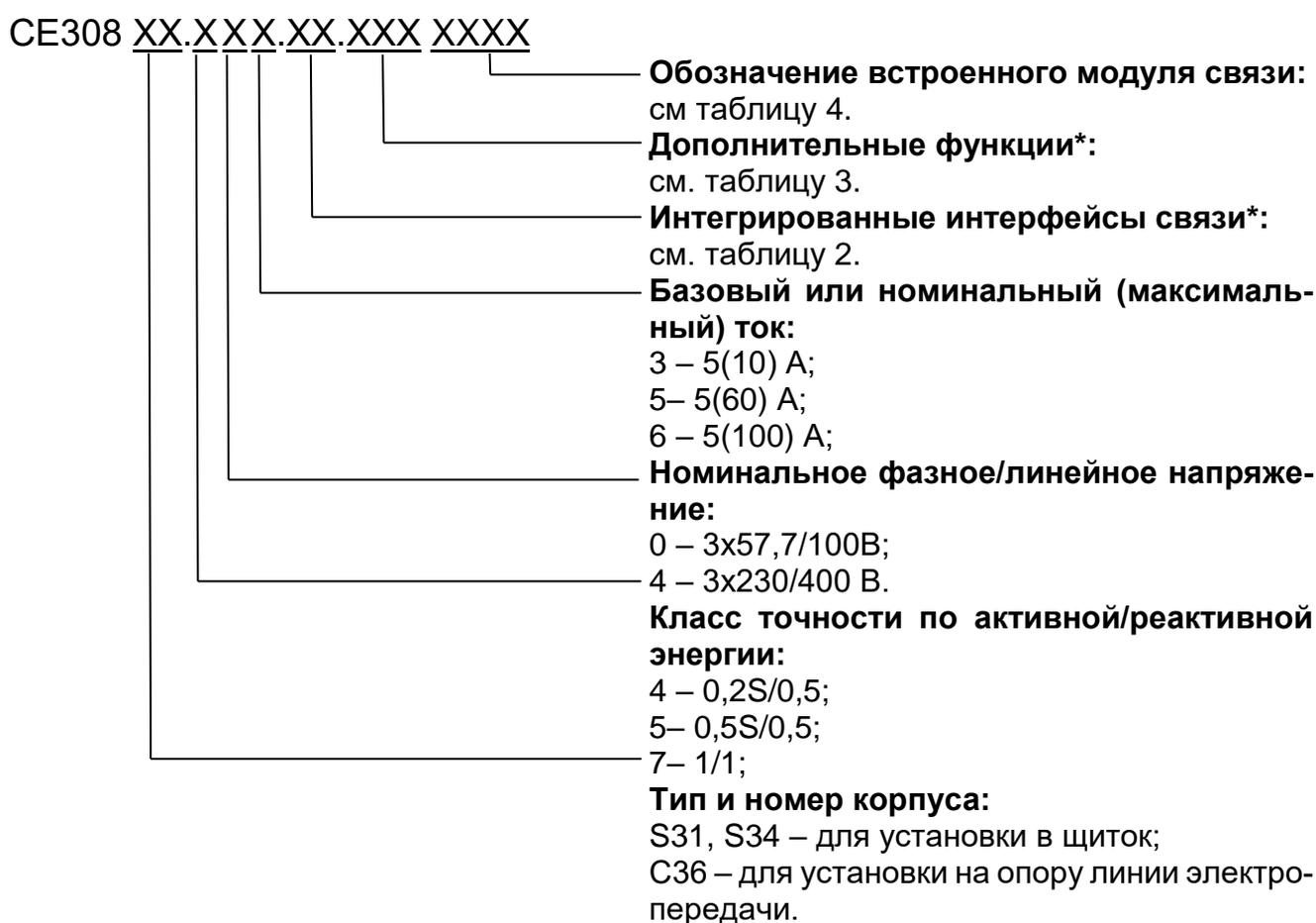
Рисунок 2 – Структура условного обозначения СЕ308
