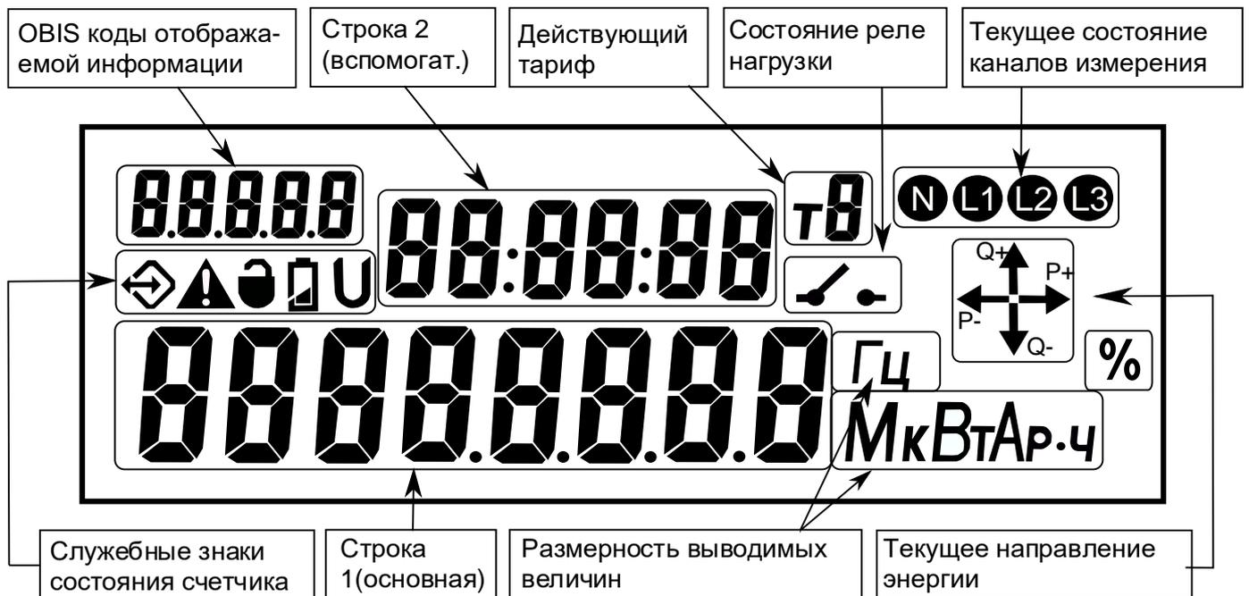
Рисунок 10 – Вид ЖКИ счетчика.
