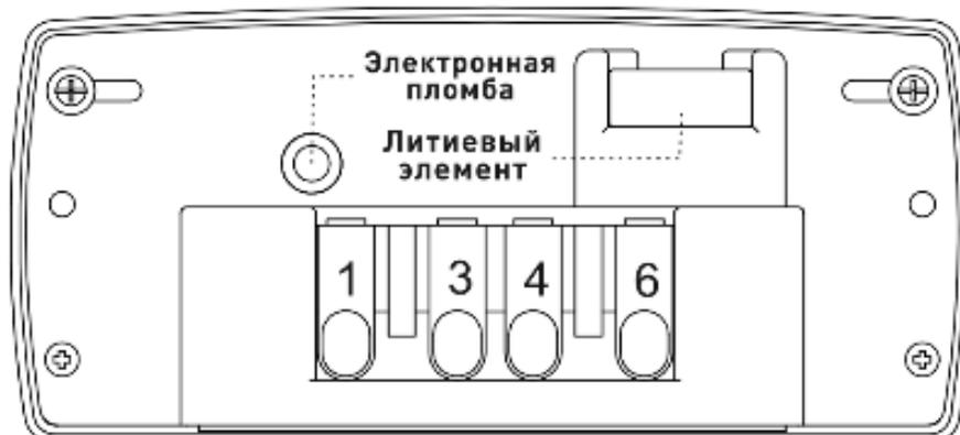
а) – первый вариант обозначения контактов зажимов счетчика СЕ208 С4
