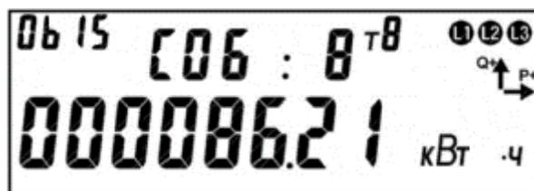
Рисунок 104 – Энергия зафиксированная по событию.
