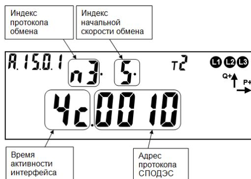
Рисунок 28 – Настройки оптического интерфейса связи по протоколу СПОДЭС
