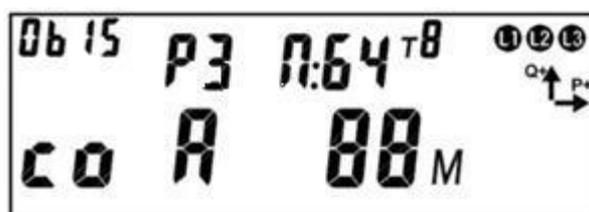
Рисунок 196 – Окно состояния реле сигнализации и РУН.
