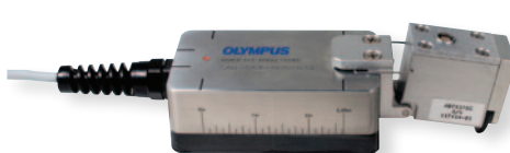
Датчик для обнаружения поверхностных трещин. На изображении показан с кодировщиком положения.
