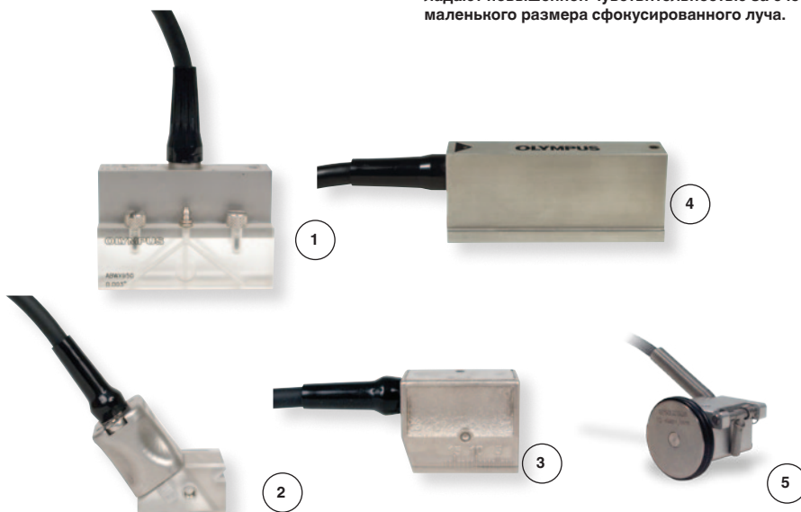
Высокоскоростное сканирование без механического перемещения. По сравнению с широким одноэлементным преобразователем, фазированные решётки обладают повышенной чувствительностью за счёт маленького размера сфокусированного луча.
