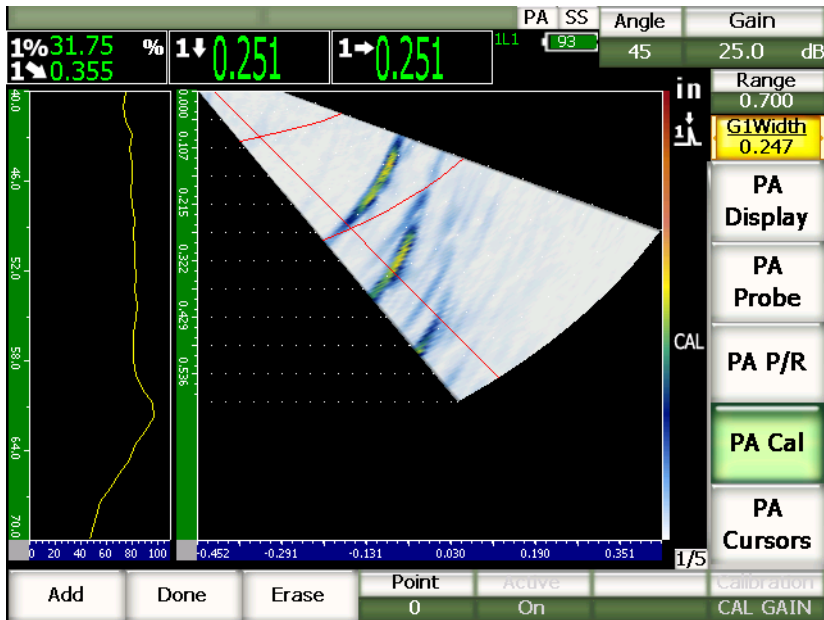
Рис. 17-26 Строб с малой шириной для получения одного эхо-сигнала
