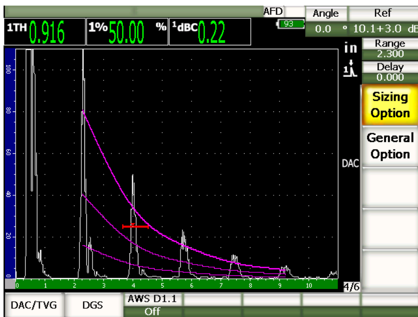
Рис. 11-11 ASME DAC с добавленным усилением 3 дБ и с коррекцией опорного усиления
