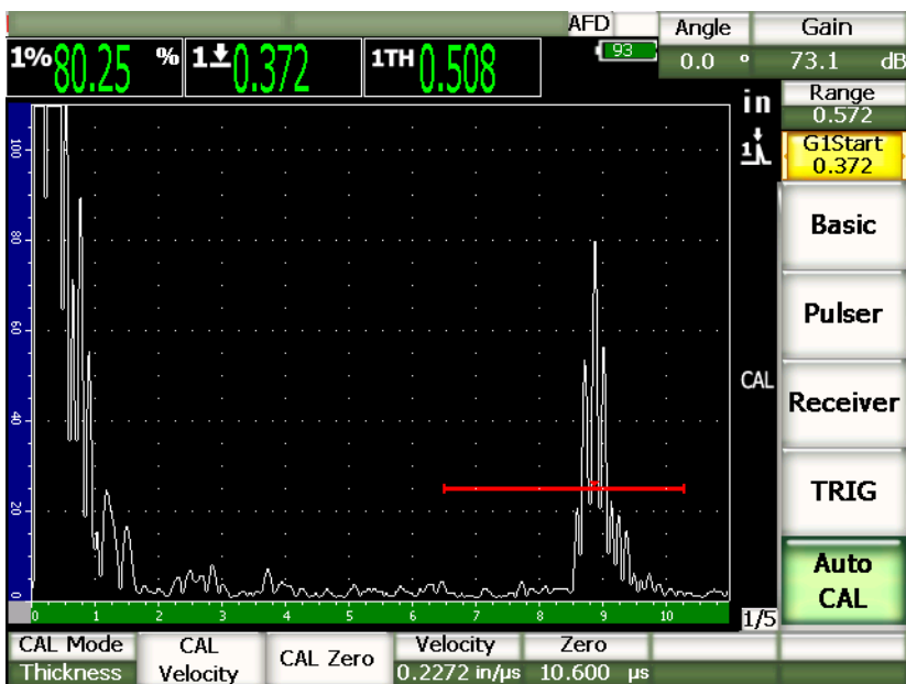
Рис. 9-6 Второй эхо-сигнал в стробе
