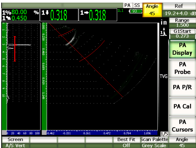
Рис. 14-10 А-скан и S-скан в серых тонах с явно видимым сигналом от дефекта
