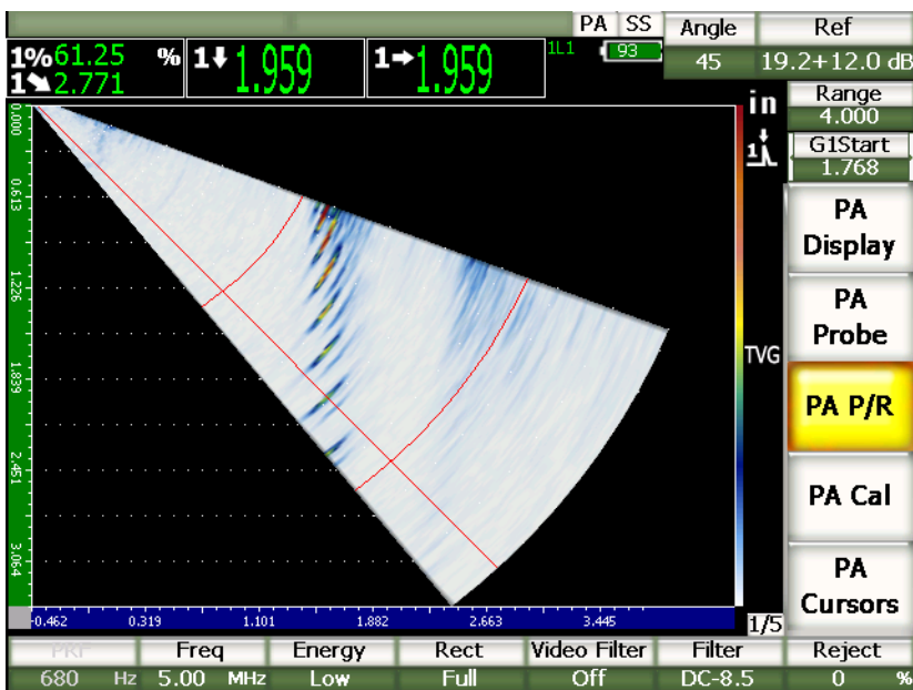
Рис. 12-2 S-скан 40°–70° с путём ультразвука 4" (100 мм)
