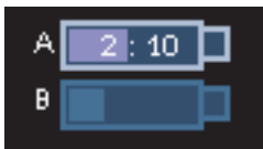
Рис. 8-2 Состояние заряда батарей: оставшийся заряд в обеих батареях
