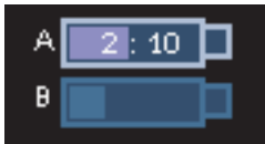
Рис. 2-4 Состояние заряда батарей: оставшийся заряд в обеих батареях
