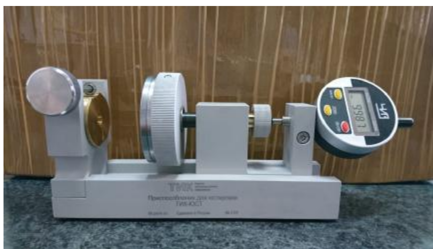
Рисунок 2 - Общий вид устройства для поверки и настройки вихретовых преобразователей ТИК-ЮСТ с цифровым индикатором
