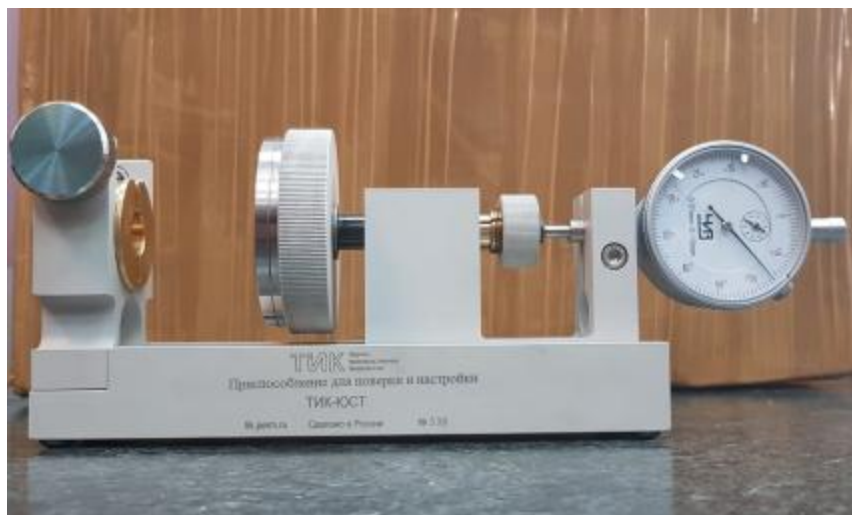
Рисунок 1 - Общий вид устройства для поверки и настройки вихретовых преобразователей ТИК-ЮСТ с индикатором часового типа
