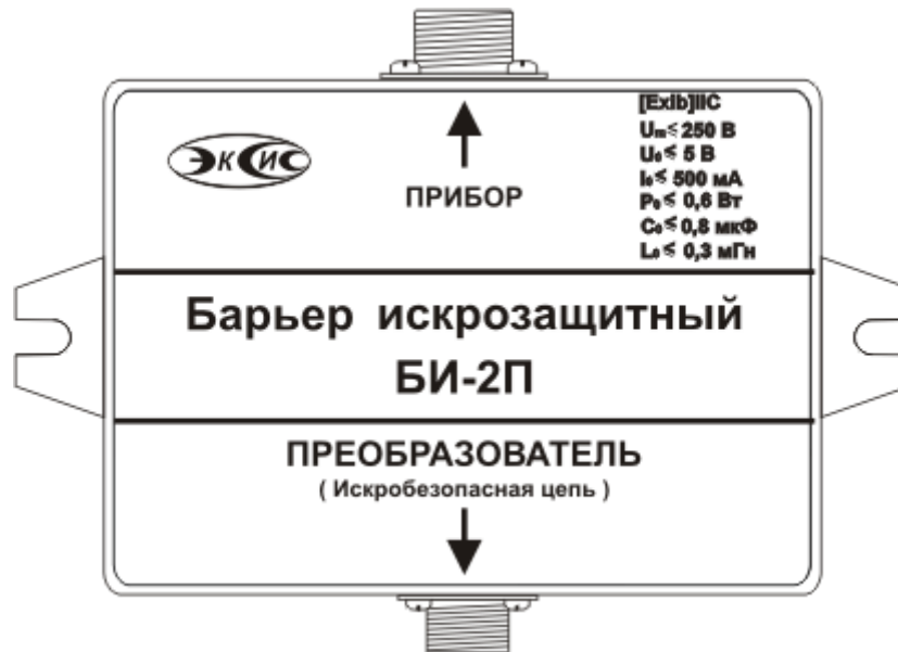
Рисунок 3.15 Барьер искрозащиты БИ-2П
