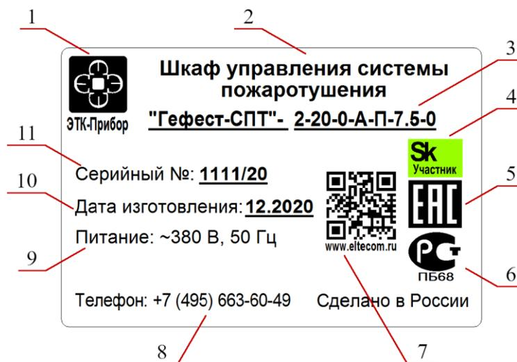
Рисунок 1.1 – Маркировка шкафа «ГЕФЕСТ-СПТ»
