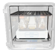
RS2 BS-010425-HK штатив для установки CPS-20 / CTR-6
