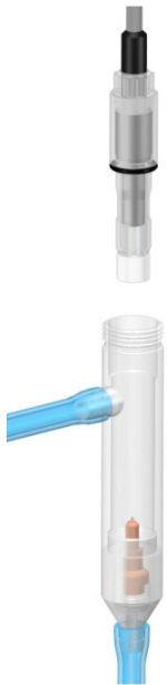
Рис. 3.9. Установка АСрО 2 в измерительную камеру
