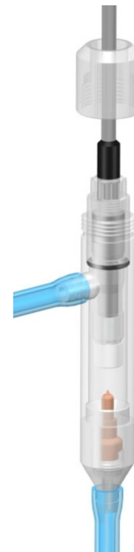
Рис. 3.10. Фиксация АСрО 2 в измерительной камере
