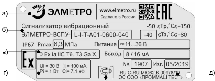
Рисунок В.3 Чертеж средств взрывозащиты. Пример таблички маркировочной.
