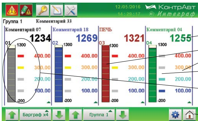
Тренд x1. Одноканальный тренд аналогового сигнала и 4-х уставок. Настройка уставок
