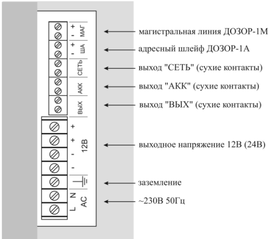
Рис.1 Расположение контактов
