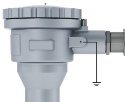
Рисунок 2.6 – Заземление реле потока
