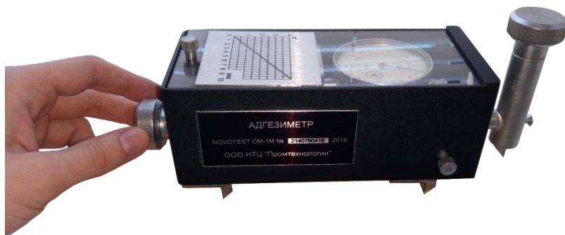
Рисунок 2.7 – Передача сдвигового усилия на нож
