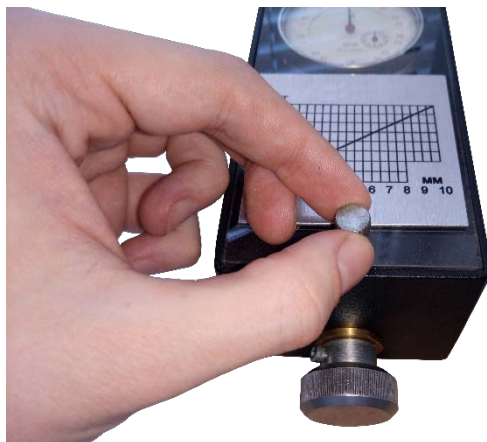
Рисунок 2.2 – Снятие защитной крышки
