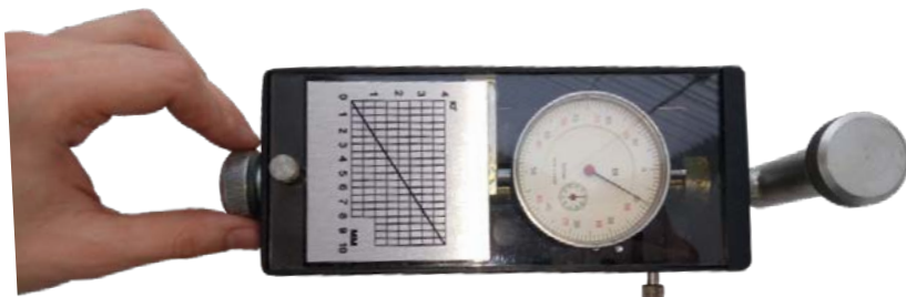
Рисунок 2.4 – Отвод ножа в исходное положение
