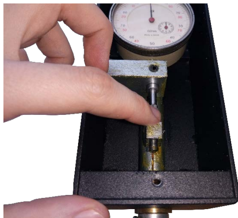
Рисунок 2.5 – Установка нуля индикатора
