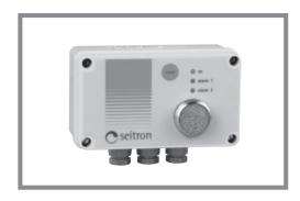
соте 30–40 см от потолка. Чтобы продлить жизнь чувствительного элемента протирайте его спиртосодержащими жидкостями (на прибор не должно подаваться напряжение).
