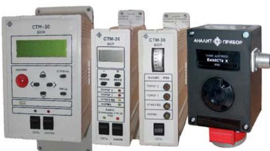
**Предназначена** для автоматического непрерывного контроля довзрывоопасных концентраций многокомпонентных воздушных смесей горючих газов и паров.
