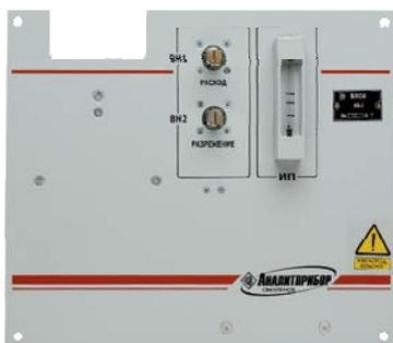
Блоки пробоподготовки БП-1 (ИБЯЛ.418311.023) и БП-1-А (атомное исполнение) (ИБЯЛ.418311.048) предназначены для подачи газовой смеси на газоанализатор, очистки ее от механических примесей, обеспечения визуального контроля расхода.
