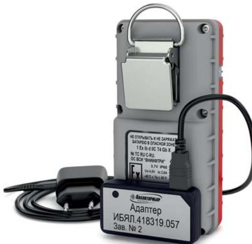
Сигнализатор соответствует требованиям ОТТ-13.040.00-КТН-038-17 «Магистральный трубопроводный транспорт нефти и нефтепродуктов. Индивидуальный газосигнализатор. Общие технические требования».
