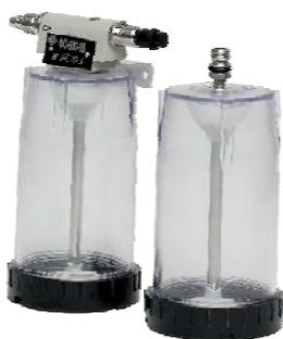
Фильтры объемные Ф0-500 (Pa2.966.015-06ПС), Ф0-0-500 (Pa2.966.015-15) предназначены для удаления крупнодисперсной пыли (Ф0-500) и понижения влагосодержания (Ф0-0-500) газовой смеси, подаваемой на вход газоанализатора.
