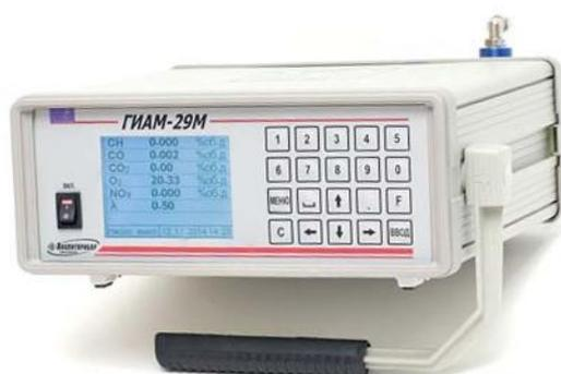
Предназначен для определения содержания оксида углерода, углеводородов, кислорода и диоксида углерода в отработавших газах двигателей внутреннего сгорания, определения частоты вращения коленчатого вала и температуры масла двигателей.
