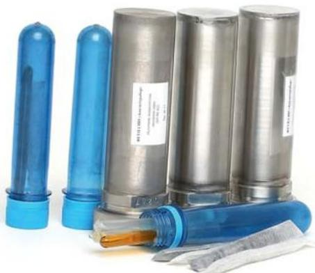
Предназначены для использования в генераторах газовых смесей, применяемых для градуировки, калибровки и поверки газоанализаторов.
