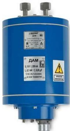
Предназначен для автоматического измерения концентрации одного компонента (кислорода, водорода, диоксида углерода, дейтерия) в воздухе рабочей зоны помещений и наружных установок.
