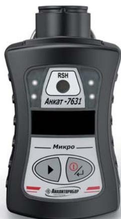
Предназначен для измерения массовой концентрации меркаптановой серы в пересчете на этилмеркаптан в газе природном или сжиженном углеводородном газе, одорированных СПМ (СПМ1) с автоматическим переводом в баллы, согласно СТО Газпром газораспределение 2.14-2016.
