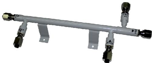
Холодильник водяной ХК-3 (ИБЯЛ.418316.001) предназначен для охлаждения газовой смеси на 2 градуса выше температуры охлаждающей воды и удаления образующегося конденсата.
