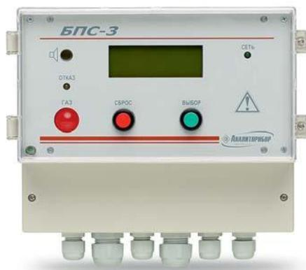
Предназначен для питания сигнализаторов СТГ-3 и СТГ-3-И при их соединении в шлейф, выдачи световой и звуковой сигнализации при срабатывании любого сигнализатора в шлейфе, с одновременным переключением «сухих контактов» реле по двум порогам.
