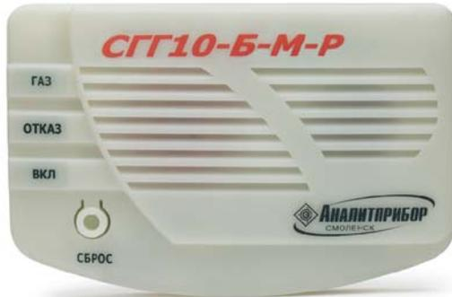
Предназначен для банкоматов с целью предупреждения попытки закачки горючего газа (пропан-бутановой смеси, метана, ацетилена и т.п.) в отделение сейфа банкомата для подрыва и незаконного изъятия денежных средств. СГГ10-Б-М-Р имеет возможность подключения в единый шлейф охранной сигнализации.
