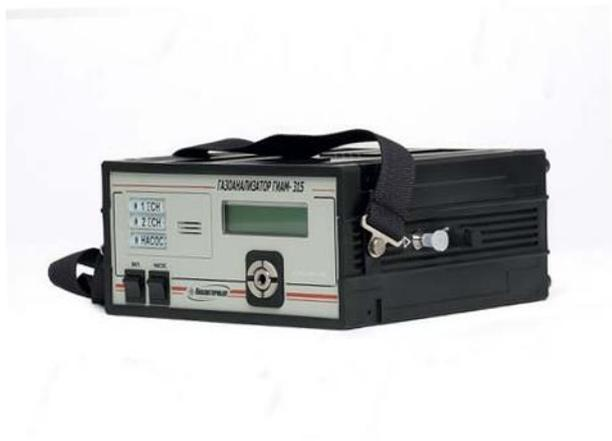
Предназначен для непрерывного автоматического измерения суммарной массовой концентрации предельных углеводородов  $C_1 - C_{10}$  (в пересчете на углерод) при контроле превышения ПДК в воздухе рабочей зоны.
