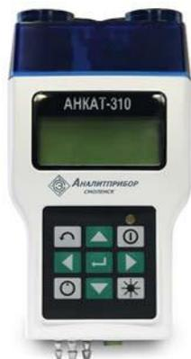
Предназначен для проведения пусконаладочных работ при эксплуатации топливосжигающих установок с целью оптимизации режимов горения, а также контроля экологически вредных выбросов. Измеряет и вычисляет компонентный состав, температуру и другие параметры дымовых газов.
