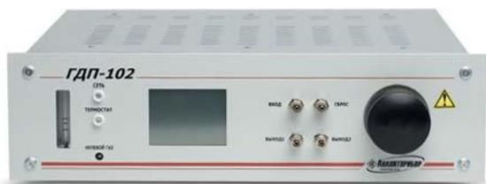
Предназначен для изготовления поверочных газовых смесей (ПГС) целевых компонентов в воздухе (азоте). Генератор применяется в комплекте с источниками микропотоков газов и паров (ИМ), изготавливаемыми по ИБЯЛ.418319.013 ТУ-2001, является рабочим эталоном 2-го разряда по ГОСТ 8.578-2008.
