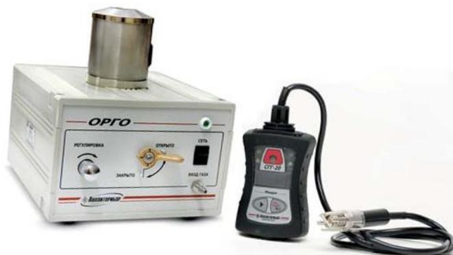
Предназначен для регулируемого разбавления природного газа воздухом при определении интенсивности запаха природного или сжиженных газов органолептическим методом по ГОСТ 22387.5-14. По определенной с помощью ОРГО интенсивности запаха возможна калибровка в баллах индикатора интенсивности запаха ИЗО-Микро.
