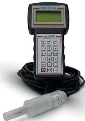
Предназначен для автоматического измерения массовой концентрации растворенного кислорода и температуры в водной среде для контроля водно-химического режима котлоагрегатов на предприятиях электро- и теплоэнергетики и других отраслей промышленности.
