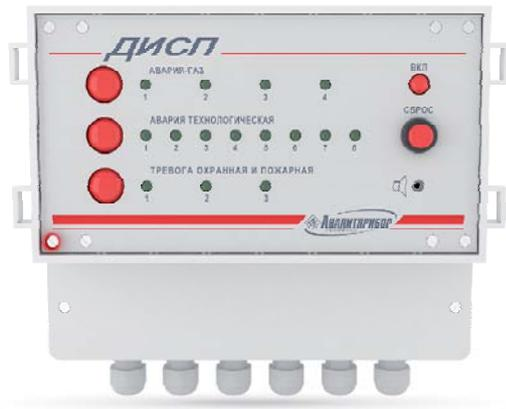
Предназначен для приема сигналов «АВАРИЯ» от сигнализаторов СГГ-6М, СОУ1, СТГ-1, а также других сигнализаторов и технических устройств, имеющих дискретный выходной сигнал; приема сигналов от датчиков аварийных параметров технологического оборудования и датчиков пожарной и охранной сигнализации, имеющих дискретный выходной сигнал; выдачи световой и звуковой сигнализации с одновременным переключением «сухих контактов» реле при поступлении на входы пульта сигналов от сигнализаторов и датчиков.
