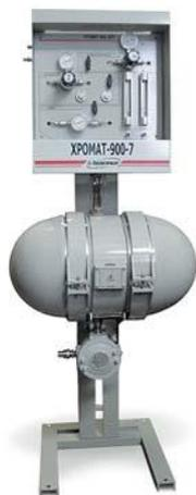
Предназначены для непрерывного автоматического измерения молярной доли азота, кислорода, диоксида углерода, углеводородов  $C_1$ - $C_5$  и  $C_6$ - $C_{n+}$  высшие, содержащихся в газе горючем природном в соответствии с ГОСТ 31371.7-2008 «Газ природный. Определение состава методом газовой хроматографии с оценкой неопределенности методики выполнения измерения молярной доли компонента».
