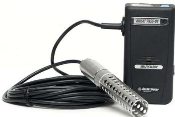
Предназначены для автоматического непрерывного измерения концентрации растворенного кислорода и температуры (только АНКАТ-7655-05) в водной среде. Для измерения концентрации растворенного кислорода при определении биохимического поглощения кислорода БПК природных и сточных вод.
