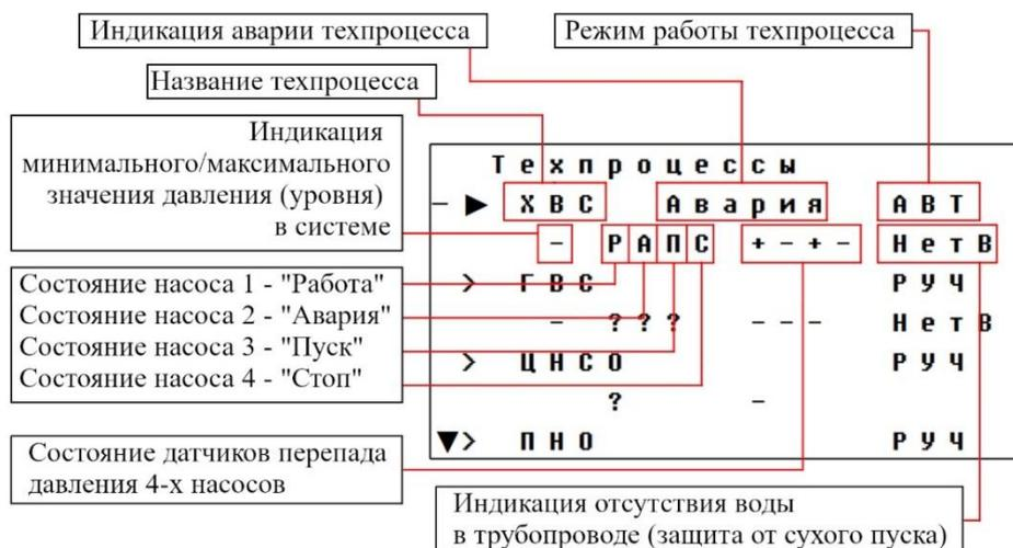
Рисунок 1.5 – Индикация состояния насосного оборудования
