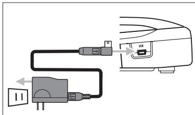
**Внимание** Следует использовать прилагающийся к устройству адаптер переменного тока (ZOOM AD-17). Использование другого адаптера может привести к поломке устройства.
