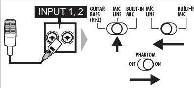
Обеспечение фантомного питания подключенным микрофонам
