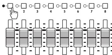
**2** Установите фейдеры мастер-трека и записываемого трека на 0 дБ, а затем, при необходимости, отрегулируйте громкость записываемого инструмента.
