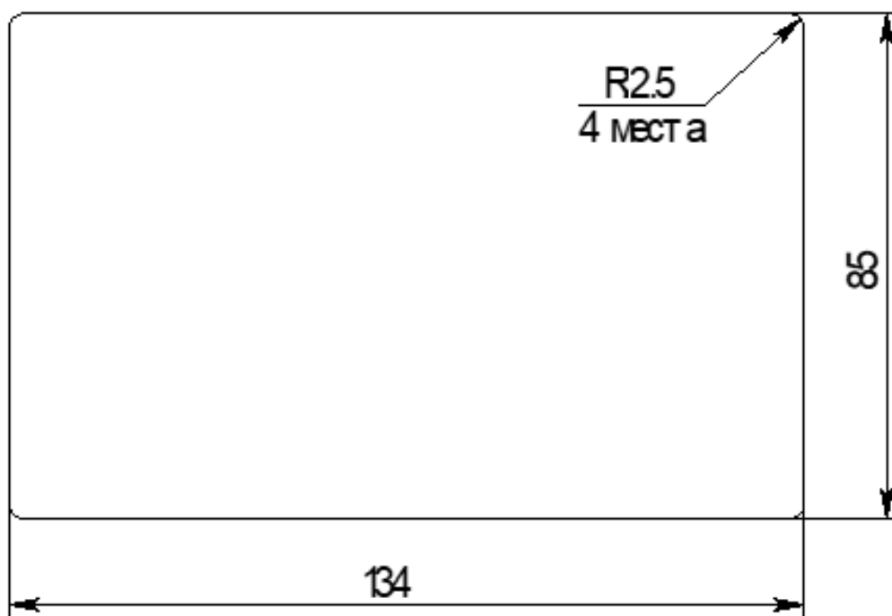
Рисунок А.6 – Размер выреза в дверце шкафа для модуля индикации ИК5 с креплением с помощью скоб, идущих в комплекте с модулем индикации
