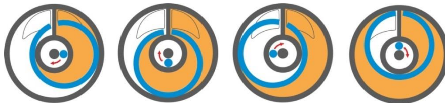
Рисунок 9 — Схема работы измерительной камеры DFM Marine
