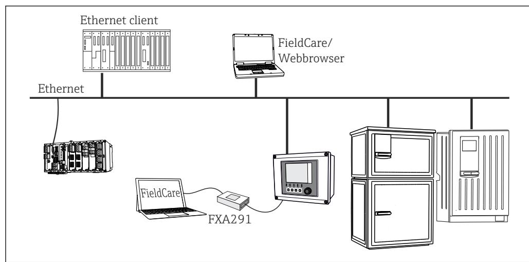
■ 27 Modbus TCP или EtherNet/IP или PROFINET
