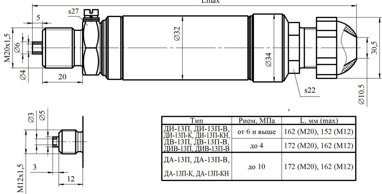
с прямым металлическим (ПММ) сальниковым вводом и гайкой под металлорукаев
