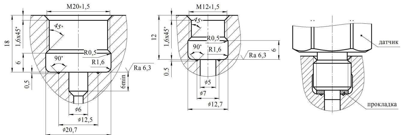
Для датчиков с приемной полостью в штуцере (M20, M12)
