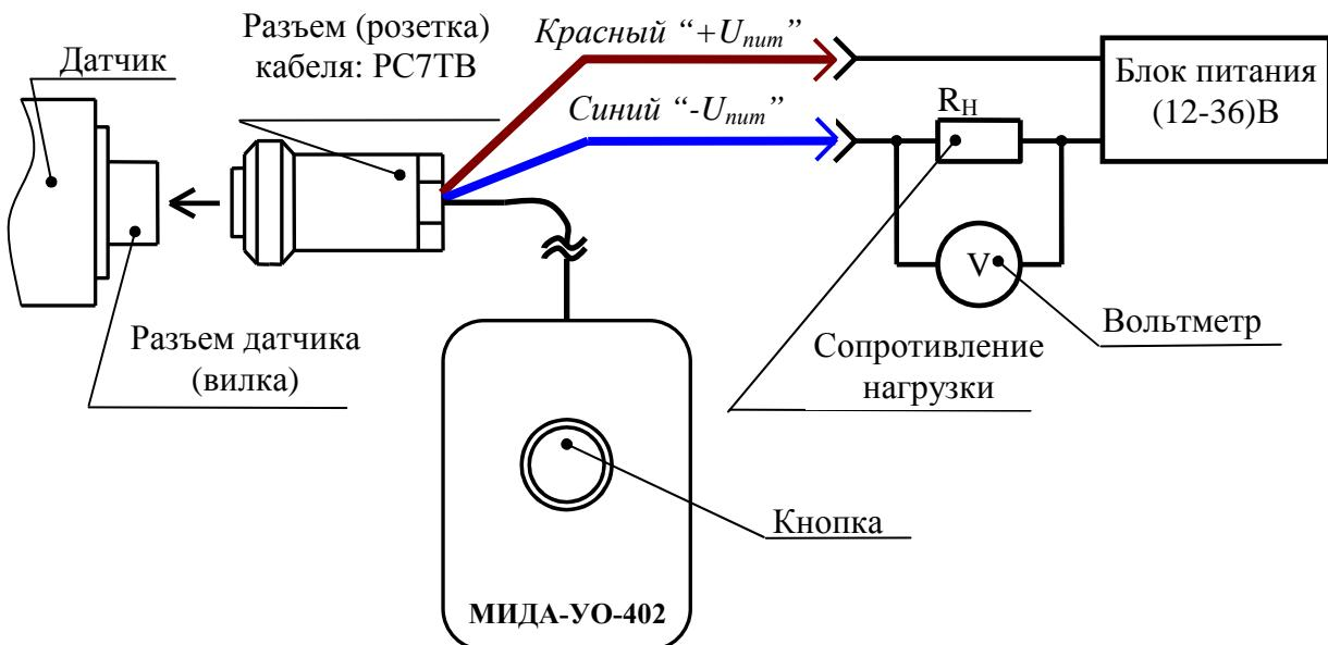
**Рисунок К4 - Подключение устройства обнуления к датчику с разъемом РСГ7ТВ**
