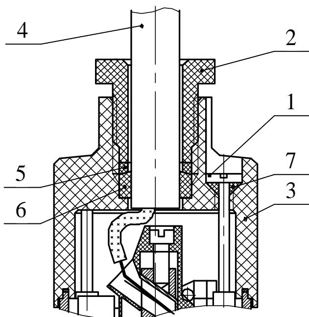
**Рисунок К1 - Сальниковый узел датчиков МИДА-13П(-Ex)-К(Н)**
