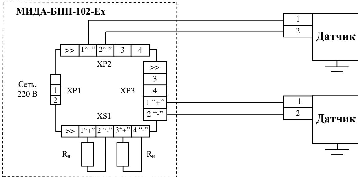
а) для датчиков с выходным сигналом (4-20) мА
