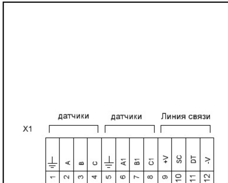
Схема подключения коммутатора СКВН
