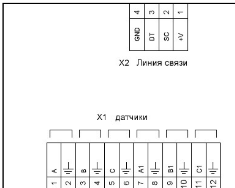
Схема подключения коммутатора СКВН2
