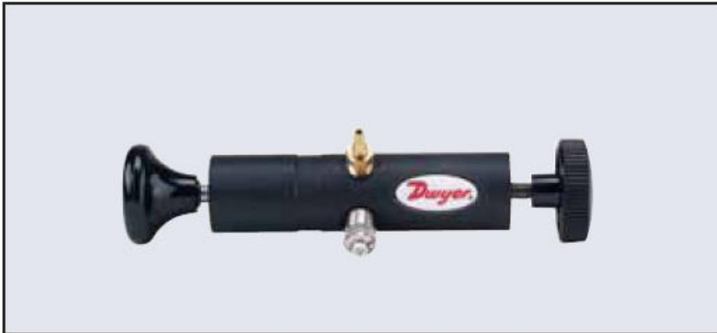
**Служит как источник давления** для калибровки измерителей и датчиков или для настройки реле давления. Используется с манометром или другим стандартным измерителем давления. Устройство включает объемный регулятор позволяющий проводить тонкую регулировку давления и выпускной клапан. Насос создает давления от 1 мм водяного столба до (5 бар). Насос имеет фитинг с насечкой, соединительный тройник и три отрезка по 90 см. виниловой трубки.
