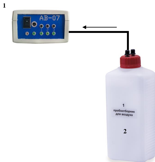
Рисунок 3.1. Схема отбора воздушной пробы.
