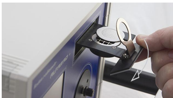
Рисунок 4д. Внешний вид БУ (Замена фильтра)
