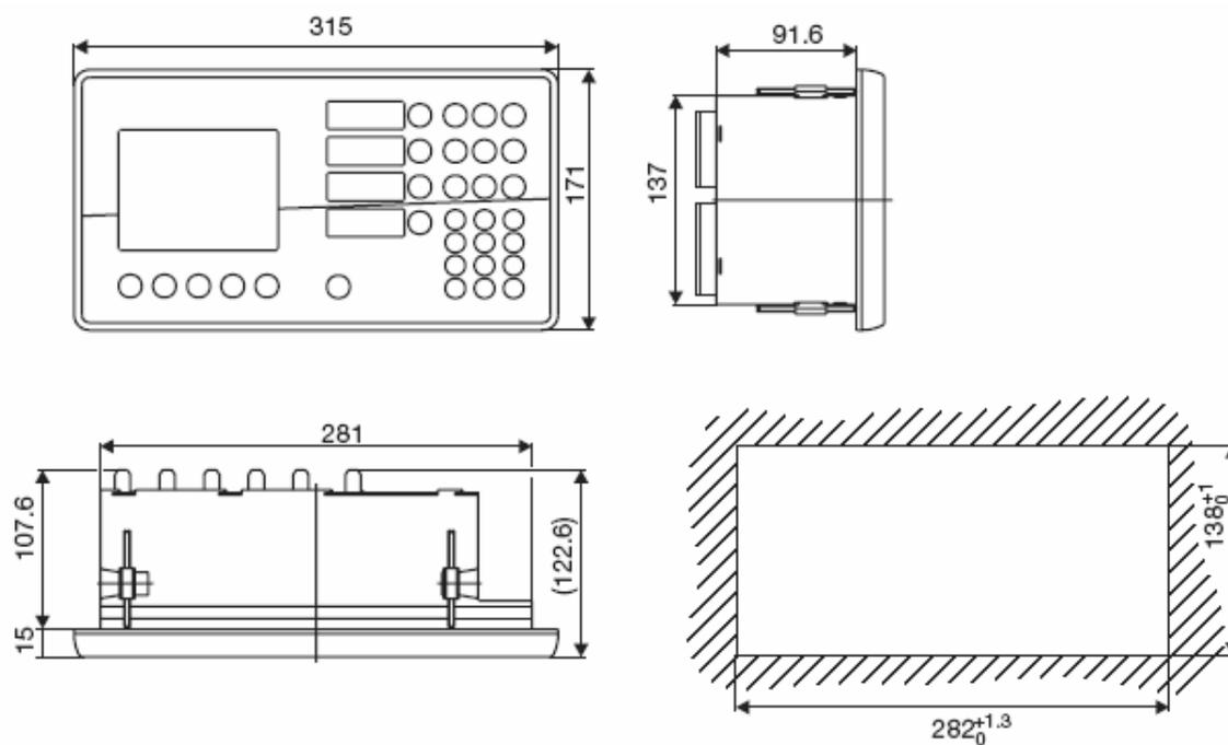
прорезь для распределительного щита DIN ISO 4370
