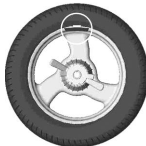
Рисунок 6.6 - Груз установлен в «12 часов»
