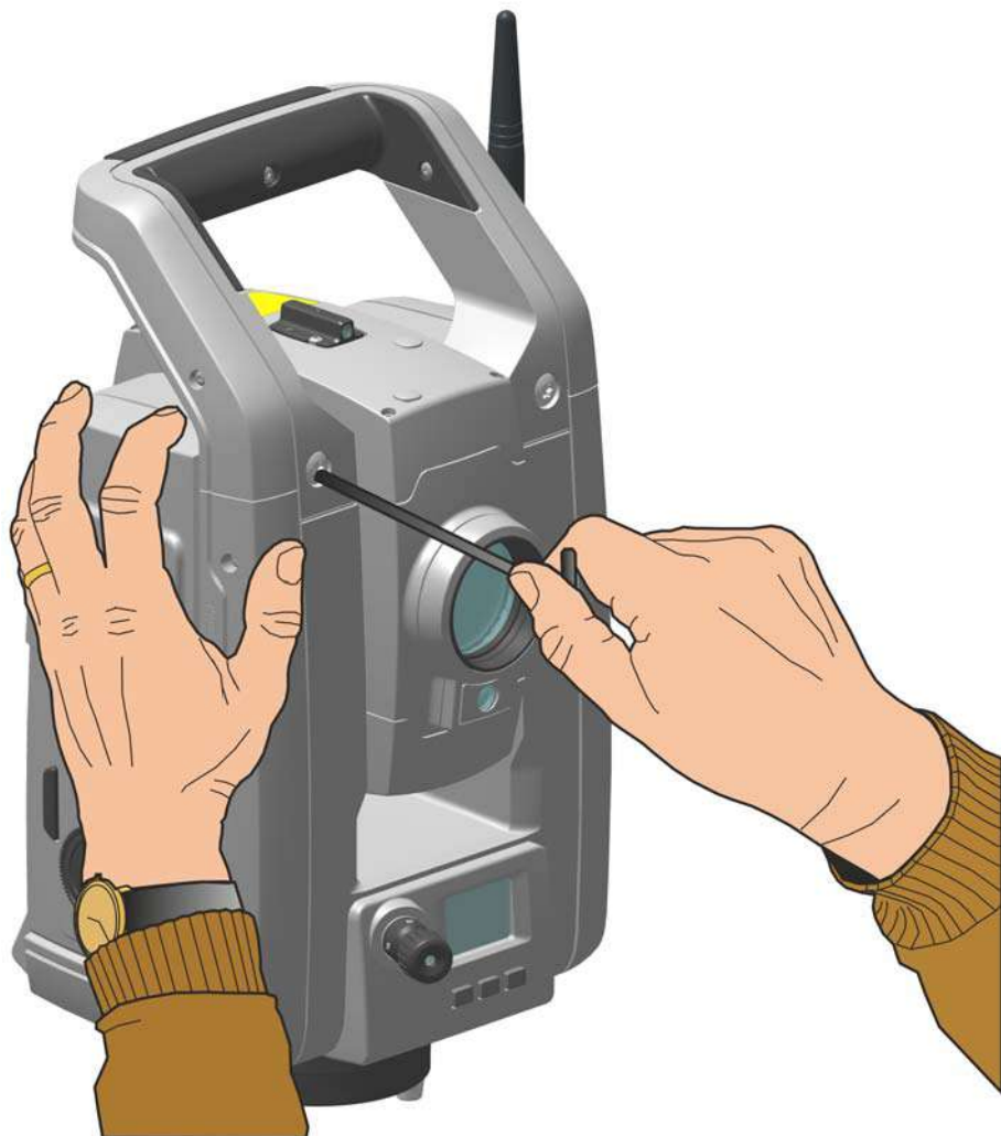
Рисунок 3.13. Отсоединение ручки инструмента
