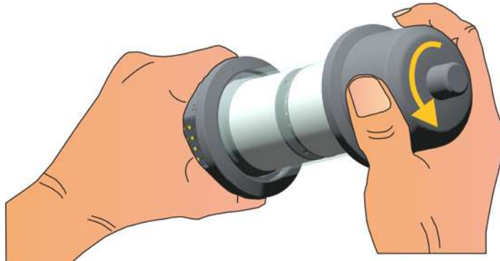
Рисунок 6.14. Так следует держать цель, открывая крышку батарейного отсека
