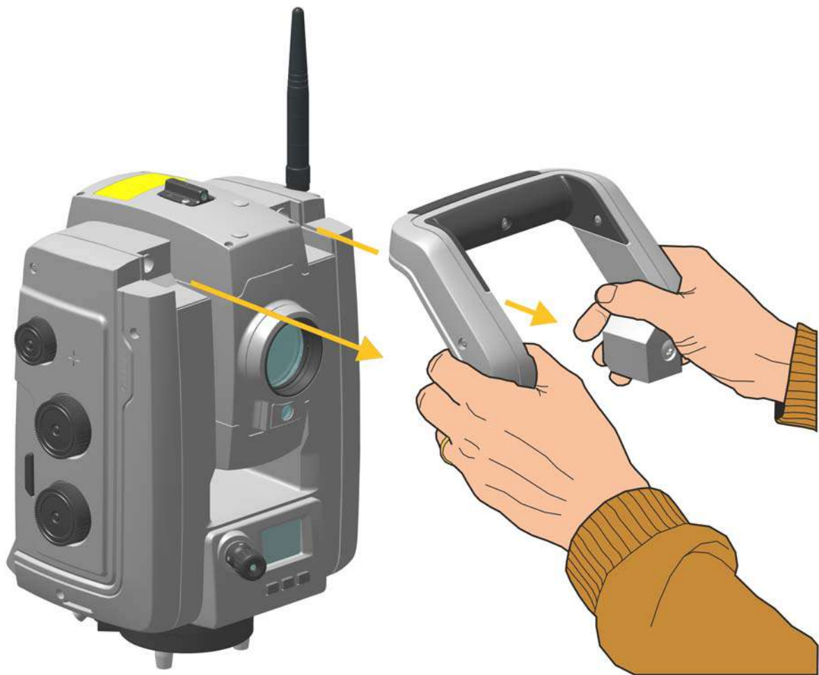
Рисунок 3.14. Отсоединение ручки инструмента
