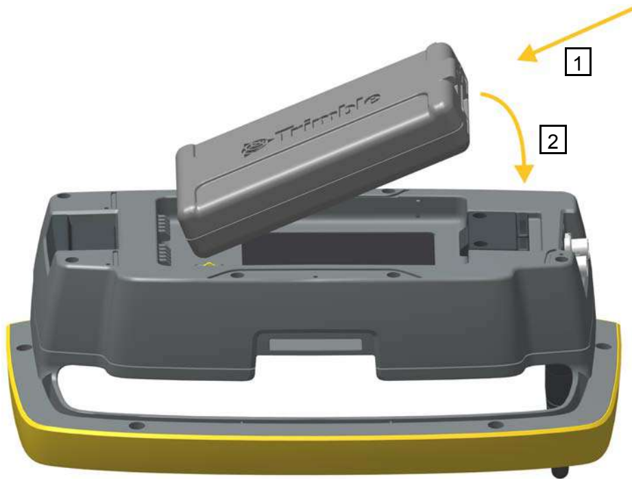
Рисунок 6.19. Установка батареи в держатель Trimble Robotic
