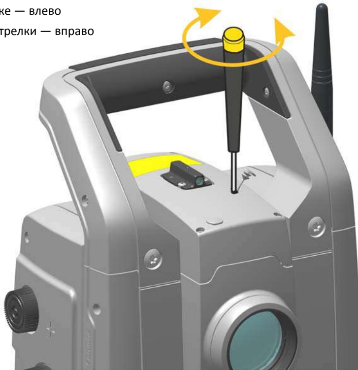
Рисунок 4.7. Юстировка положения лазерного указателя по горизонтали
