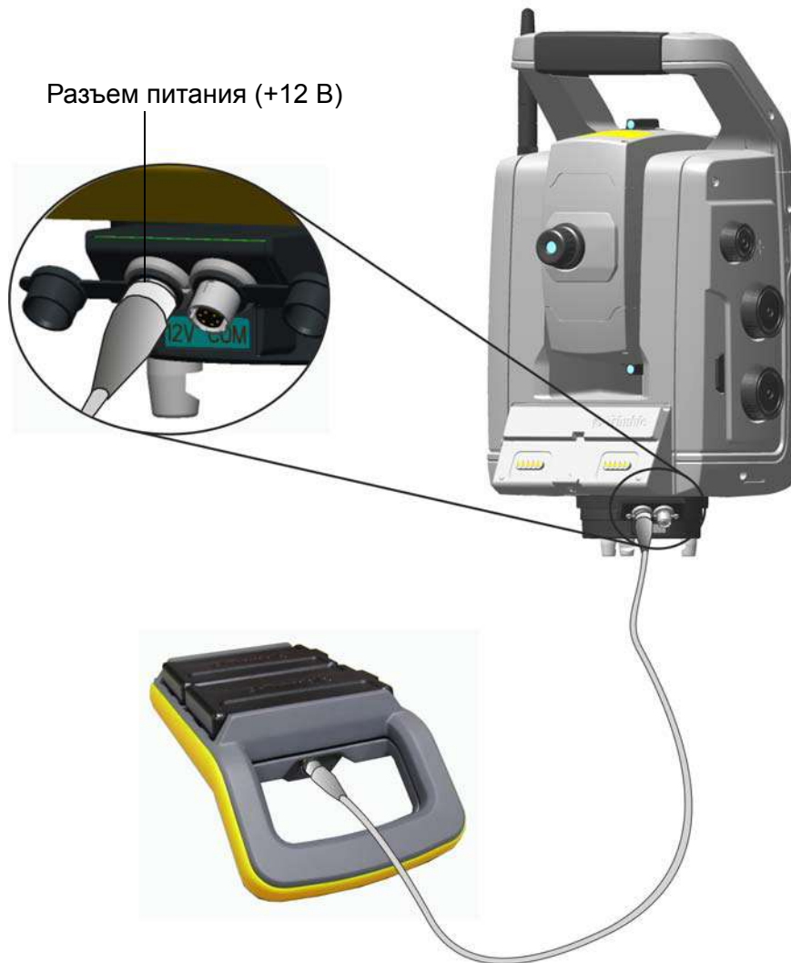
Рисунок 6.2. Подключение адаптера для нескольких батарей
