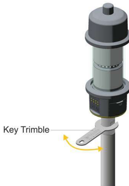
Рисунок 6.17. Установка и снятие цели Trimble Active Track 360
