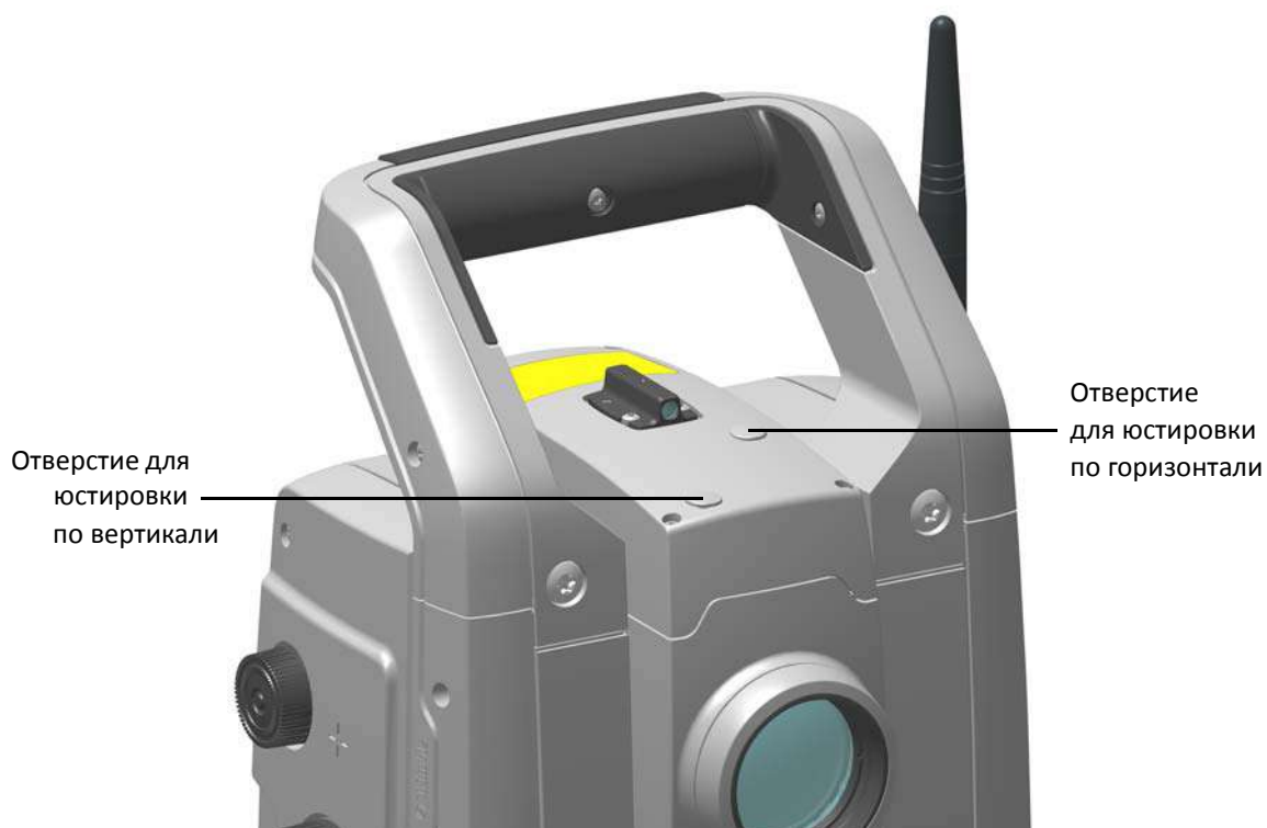
Рисунок 4.5. Отверстия юстировочных винтов лазерного указателя
