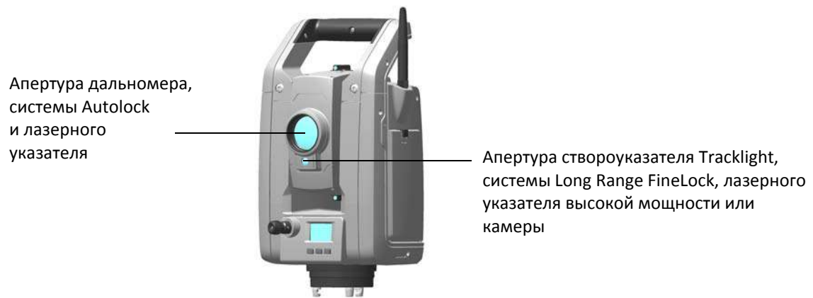
Рисунок 1.1. Апертуры тахеометра Trimble S7
