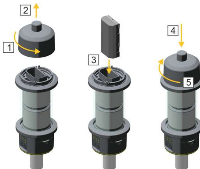
Рисунок 6.15. Установка батареи в цель Trimble Active Track 360
