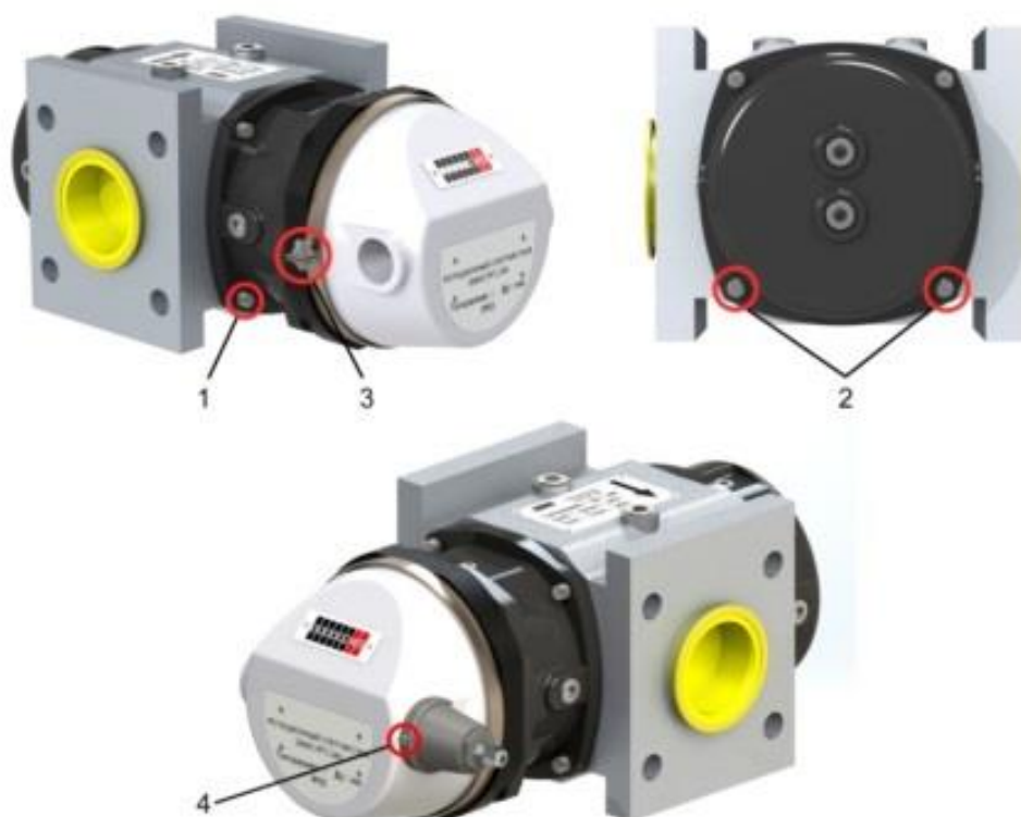
Рисунок 1.9 – Схема пломбирования счетчика
