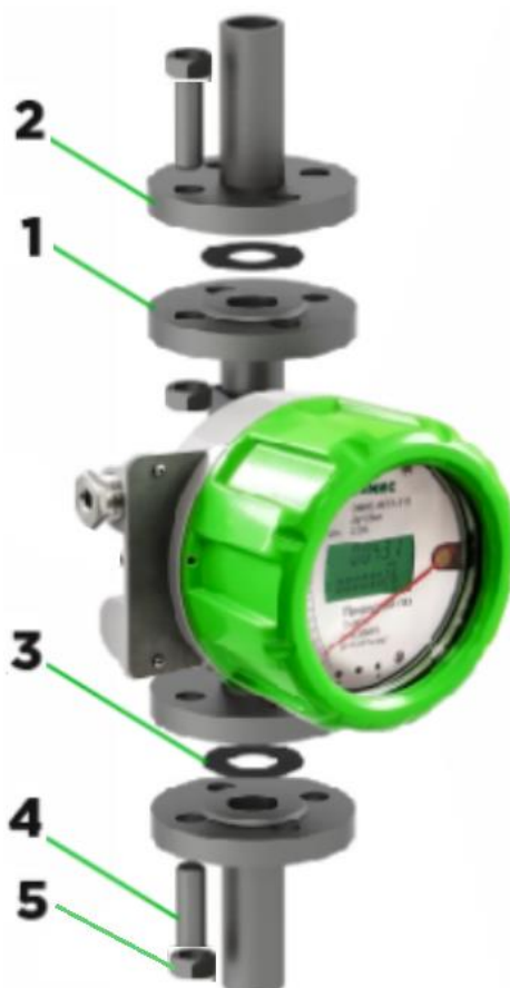
Рисунок 2.6 – Установка ротаметра с фланцевым присоединением к трубопроводу
