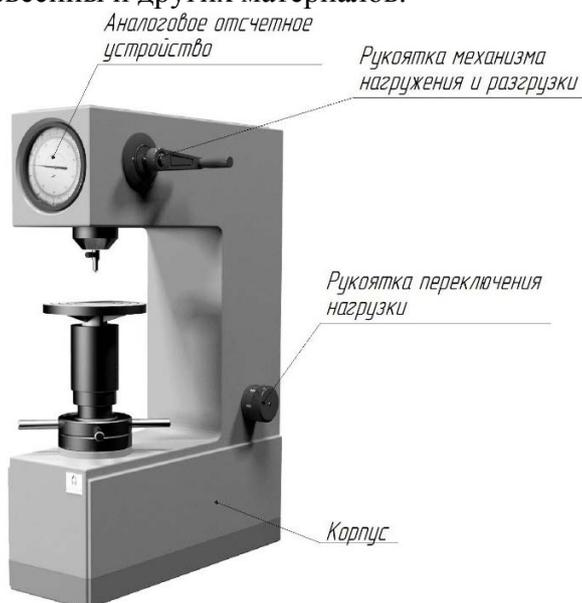
Конструктивно твердомер состоит из механизмов нагрузки и разгрузки, подъема рабочего стола, аналоговой измерительной системы.
