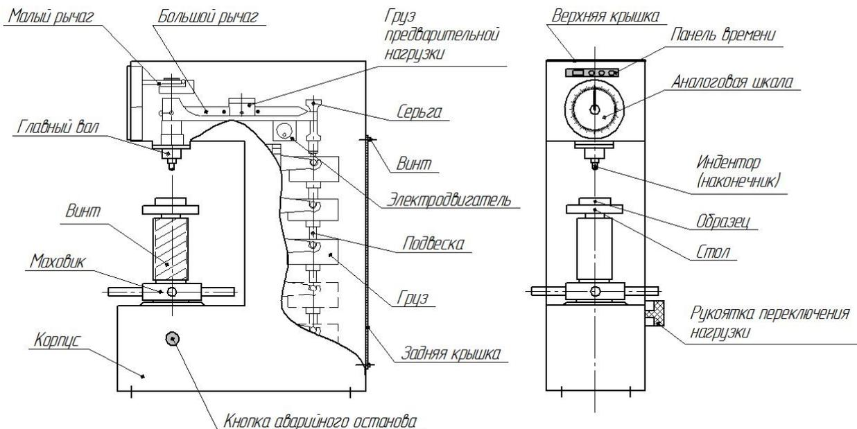
Определение твердости осуществляется путем погружения индентора (далее «индентор» или «наконечник») под действием стандартного усилия в исследуемую поверхность образца с последующим определением глубины внедрения.
