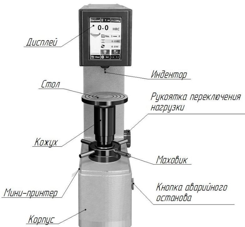
Конструктивно твердомер состоит из механизмов нагрузки и разгрузки, подъема рабочего стола, микропроцессорного блока.
