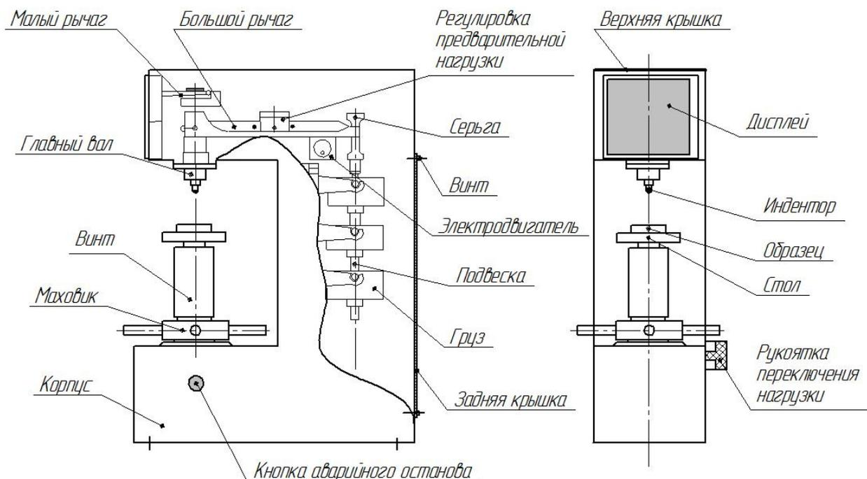
Определение твердости осуществляется путем погружения индентора (далее «индентор» или «наконечник») под действием стандартного усилия в исследуемую поверхность образца с последующим определением глубины внедрения.
