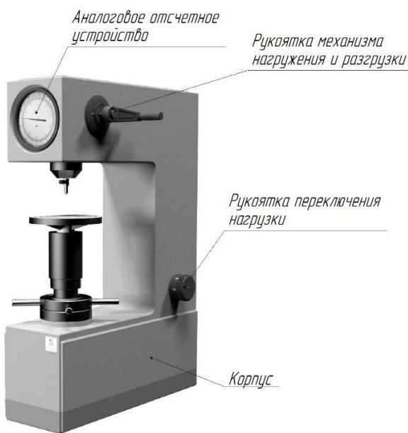
Твердомеры модификации «ИТР-М» позволяют измерять твердость мелких деталей, деталей с упрочненными поверхностными слоями, алюминиевых сплавов, тонких плит и других материалов. Твердомеры обеспечивают испытания в диапазоне нагрузок от 15 кгс до 45 кгс.
